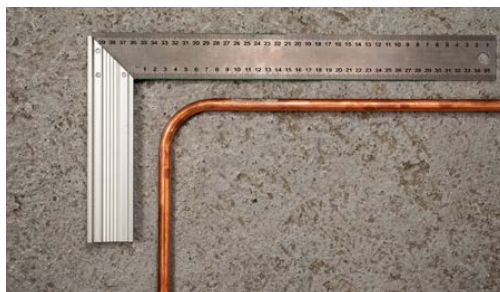
Fig. 5 Tube en cuivre cintré à 90° © Thierry NAJEAN
